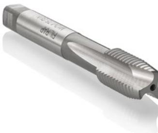
**Taraud finisseur** manuel ou machine pour trous débouchants et trous borgnes. Pour les diamètres supérieurs à M24 ou pour l'utilisation dans des matières dures, il s'utilise à la suite du taraud ébaucheur.
